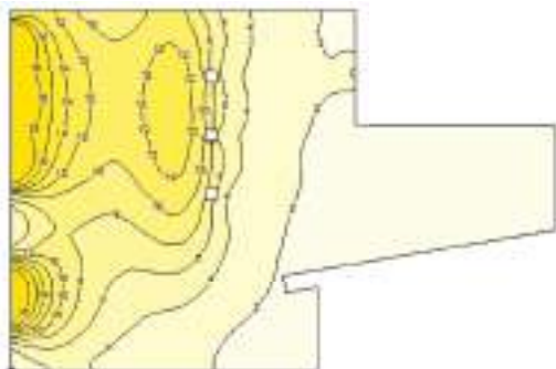
Figuur 10.49. Daglichtfactor verdeling in de ronde woonkamer met zonneschoorsteen variant 2 met een houten plaat
