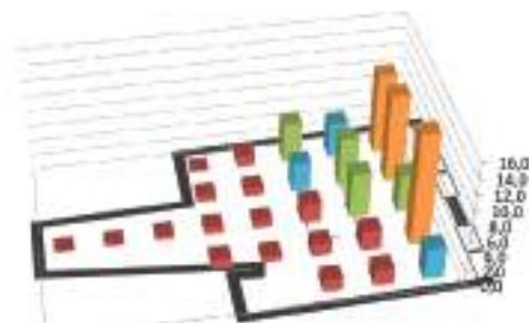
Figuur 10.33. Daglichtfactor verdeling in het schaalmodel met zonneshoorsteen variant 1, met een zwarte plaat op het noorden
