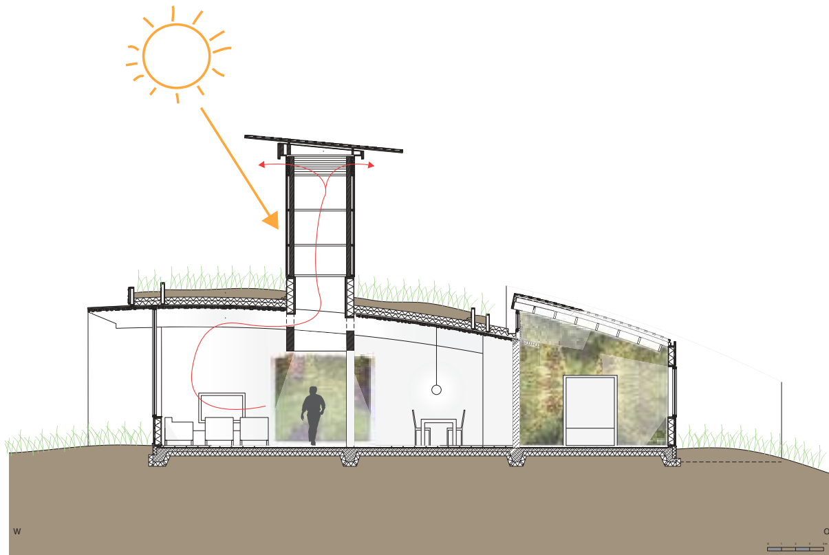
Figuur 7.52. Klimaatschema voor de ventilatie van de ronde woning op een stralingsrijke dag
