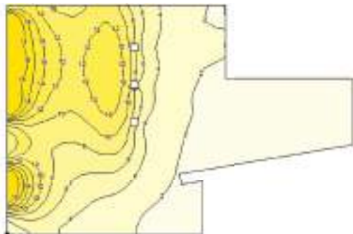
Figuur 10.51. Daglichtfactor verdeling in de ronde woonkamer met zonneschoorsteen variant 2 met een witte plaat
