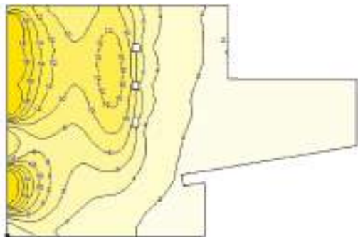
Figuur 10.50. Daglichtfactor verdeling in de ronde woonkamer met zonneschoorsteen variant 2 met een zwarte plaat
