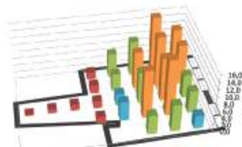
Figuur 10.34. Daglichtfactor verdeling in het schaalmodel met zonneshoorsteen variant 2, met een houten plaat op het noorden
