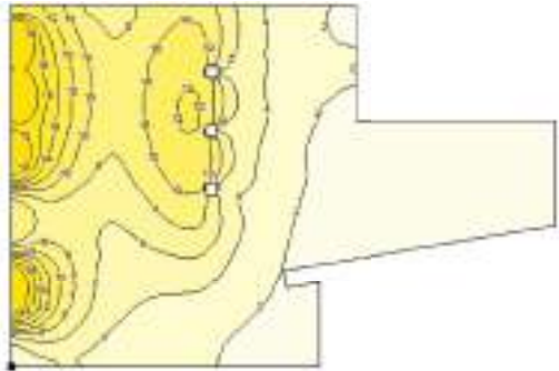
Figuur 10.48. Daglichtfactor verdeling in de ronde woonkamer met zonneschoorsteen variant 1 met een zwarte plaat
