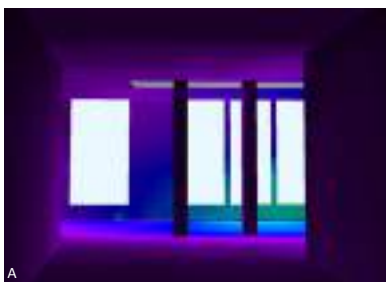
Figuur 10.27. Luminantie render vanuit de keuken naar de ronde woonkamer. Render A geeft de oorspronkelijke situatie aan. Render B heeft een extra daklicht in de keuken. Render C heeft een extra daklicht in de keuken en wit geverfde kolommen.
